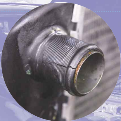
純正ラジエーターを外して観察してみると、アッパーホースの取り付け部にこのようにパッカリと割れた亀裂が見つかった。はつきりしないけれど、組み込み時の締め付け過ぎが原因らしい。
